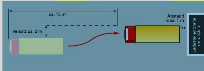
Rückwärtsfahren und versetzen nach rechts an eine Rampe zum Be- oder Entladen.
